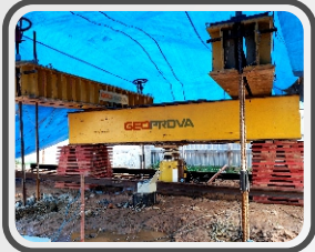
Prova de carga estática em estacas (PCE)
