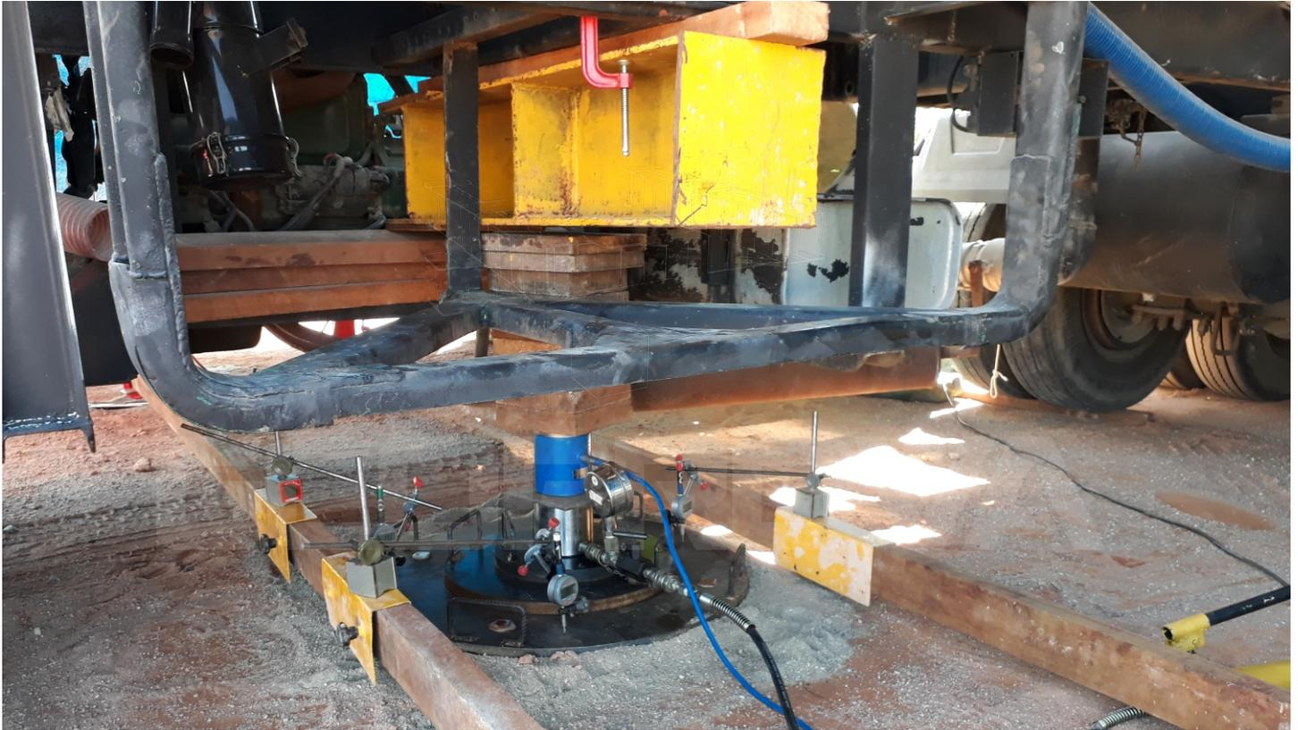
As provas de carga são procedimentos de “simulação” do carregamento real sobre o elemento de fundação, seja ela rasa (Prova de carga em placa – NBR 6.489) ou profunda (Prova de carga sobre estacas ou tubulões – NBR 16.903).
